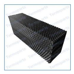
O enchimento filme pode ser fabricado com canais cruzados ou verticais, e são fornecidos em blocos constituídos de folhas termoformadas coladas, encaixadas ou soldadas, sendo essa última a mais recomendada pela sua longa durabilidade e maior resistência mecânica.
